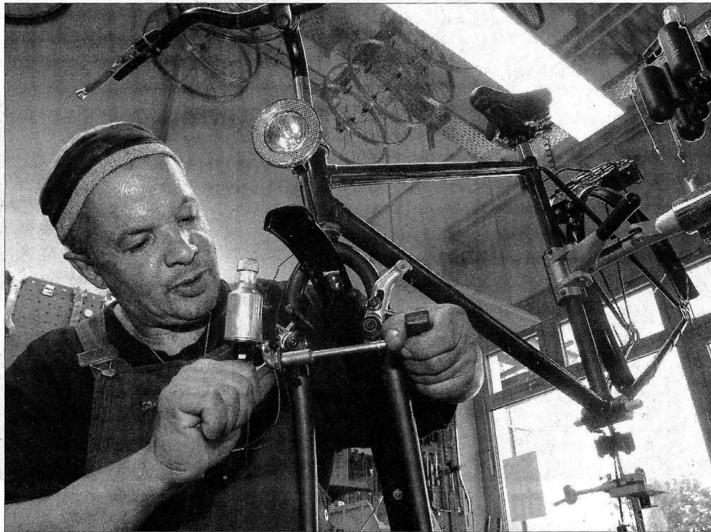
Wenn Fahrräder schweben: Der Rahmen ist in einen Montageständer eingespannt. Mechaniker Joe Voutta tauscht Bremsbeläge aus. Beim Dynamo Fahrradservice werden die meisten Reparaturen in 24 Stunden erledigt. Foto: Klaus Brenninger
